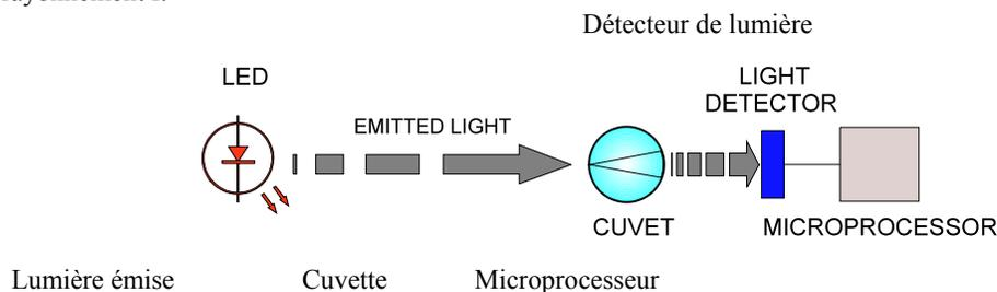
Une diode électroluminescente monochromatique (Led) émet un rayonnement à une longueur d'onde unique éclairant le système avec une intensité lumineuse  $I_0$ .
