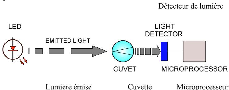
Une diode électroluminescente monochromatique (Led) émet un rayonnement à une longueur d'onde unique éclairant le système avec une intensité lumineuse  $I_0$ .
